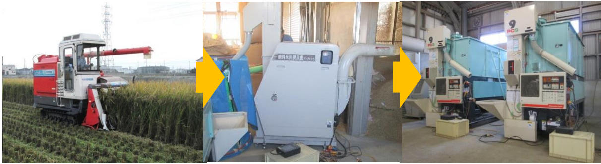
収穫(自脱型コンバイン) 脱ぶ(インペラ式籾摺り機) 乾燥(循環式乾燥機)
