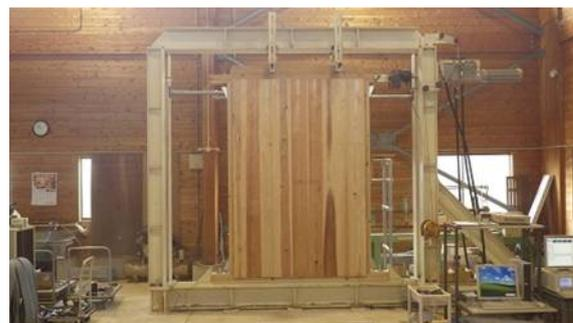
スギ厚板張り床面の面内せん断試験
