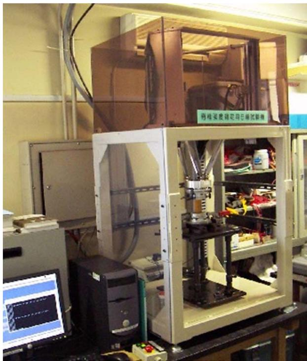
図 2 6 軸材料試験機(旧型)
