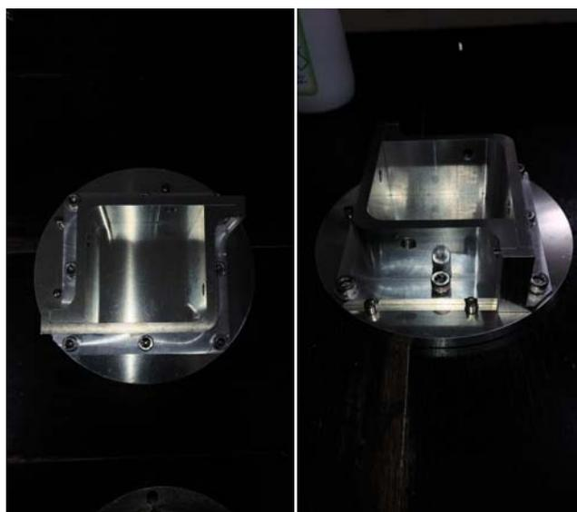
図 6 試料の固定治具(新型)
