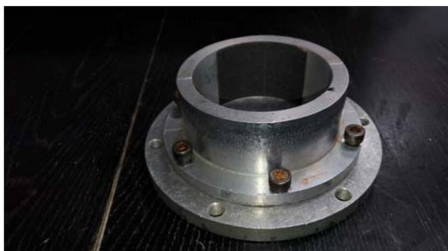
図 4 試料の固定治具(旧型)
