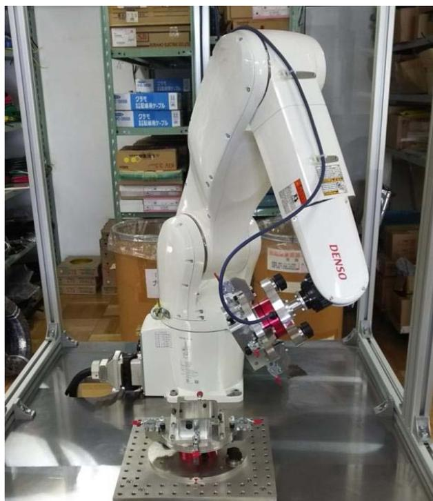
図 5 6 軸材料試験機(新型)
