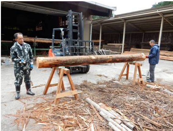
打撃法によりヤング率等を推定
