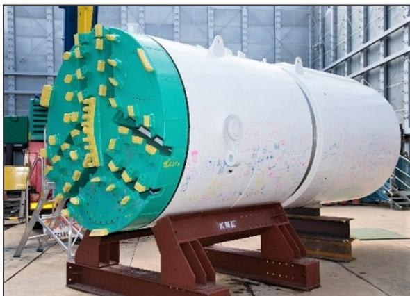
φ 1200 配水管工事（シールド掘進機）
