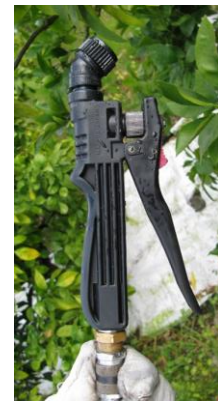
Y社製の特別仕様水噴射ノズル。ポンプ圧力は30kg/cm 2 。・噴出水量43.8ml/秒
