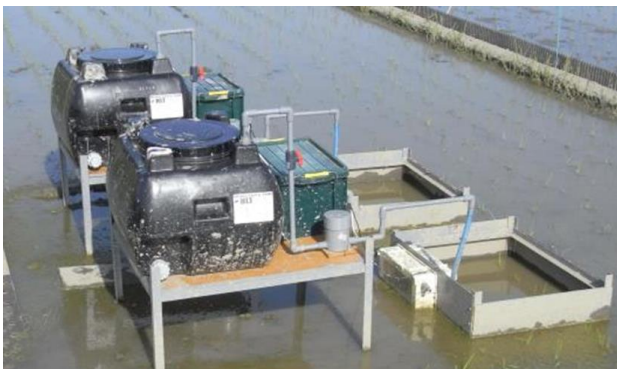
水位調節枠装置ほ場設置写真
