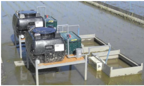
図1 水位調節枠装置ほ場設置写真
