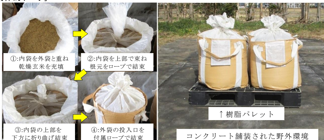
図 1. 飼料用米の充填から内袋結束作業および野外での保管状況
