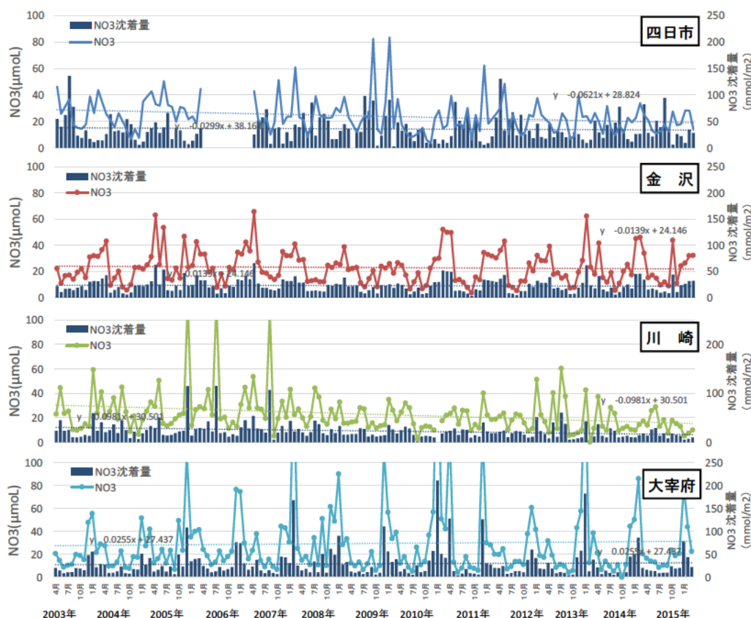
図4 四日市、金沢、川崎、大宰府における雨水中の \text{NO}_3^- イオン濃度および \text{NO}_3^- 沈着量の経時変化
