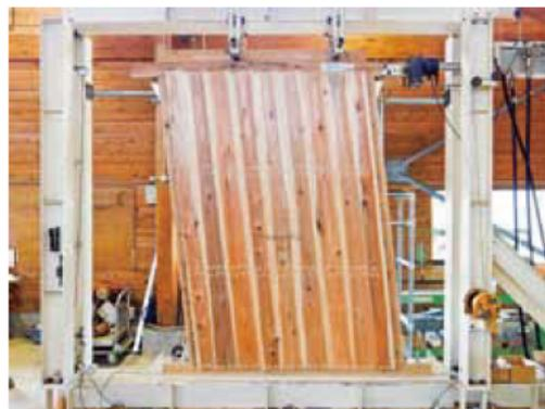
写真-1. スギ厚板張り床構面の耐力試験。
