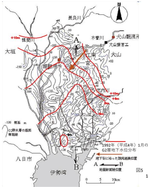
図5 G2層基底面の起伏と1994年1月の地下水位分布との関係 (農研機構, 2020.210閲覧)
