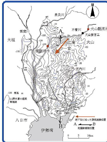
図1 濃尾平野のG2帯水層の基底面分布図
