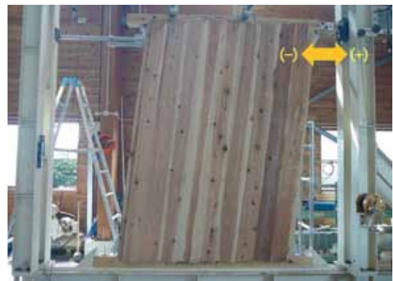
写真-1. 面内せん断試験の様子（最終加力後）
