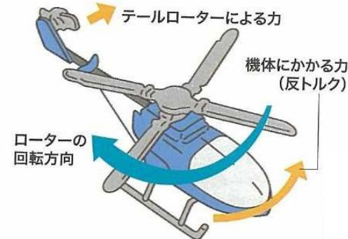
メインローターで揚力を得て、テールローターで反トルクを打ち消して機首の向きを保ちます。
