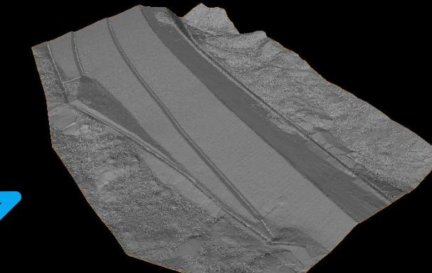
設計と計測面の差異の算出
