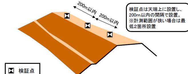
図 4-1 精度確認試験の配置イメージ図
