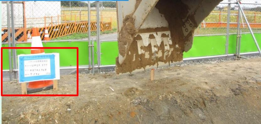
作業装置の摩耗、機械ガタの変化等により、精度が低下するため、日々『バケット位置精度の確認』を実施する。
