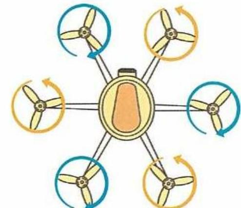
隣合うロータが反対方向に回転し反トルクを打ち消し
