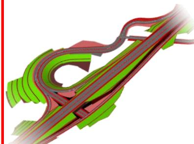
施工段階の一連の利用の前提として、施工前に契約図書を3次元化。
