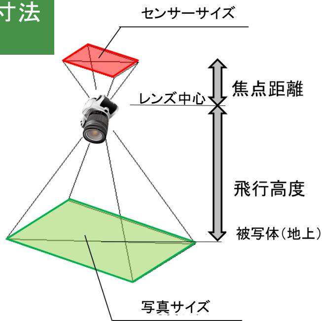
$$\frac{\text{センサーサイズ}}{\text{焦点距離}} = \frac{\text{写真サイズ}}{\text{飛行高度}}$$
