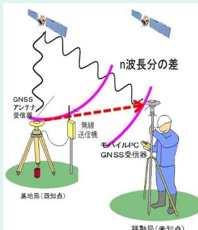
nを確定させるために、5つの衛星の搬送波を同時に解析する。
