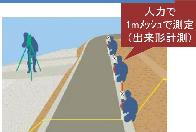
出来形計測の場合、点密度で1m間隔以内(1点/m<sup>2</sup>以上)で概ね等間隔で得られるよう計測する。
