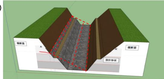
※TS測量による場合は、UAV/TLS測量と同様に測定精度は10cm以内、計測密度は0.25m<sup>2</sup>(50cm×50cm)あたり1点以上です。
