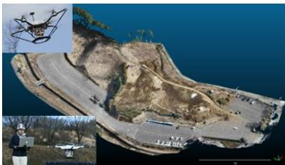
UAV等による写真測量等により、短時間で面的(高精度)な3次元測量を実施。
