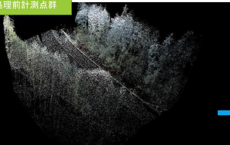
クリーニング済み計測点群 → TINに変換
