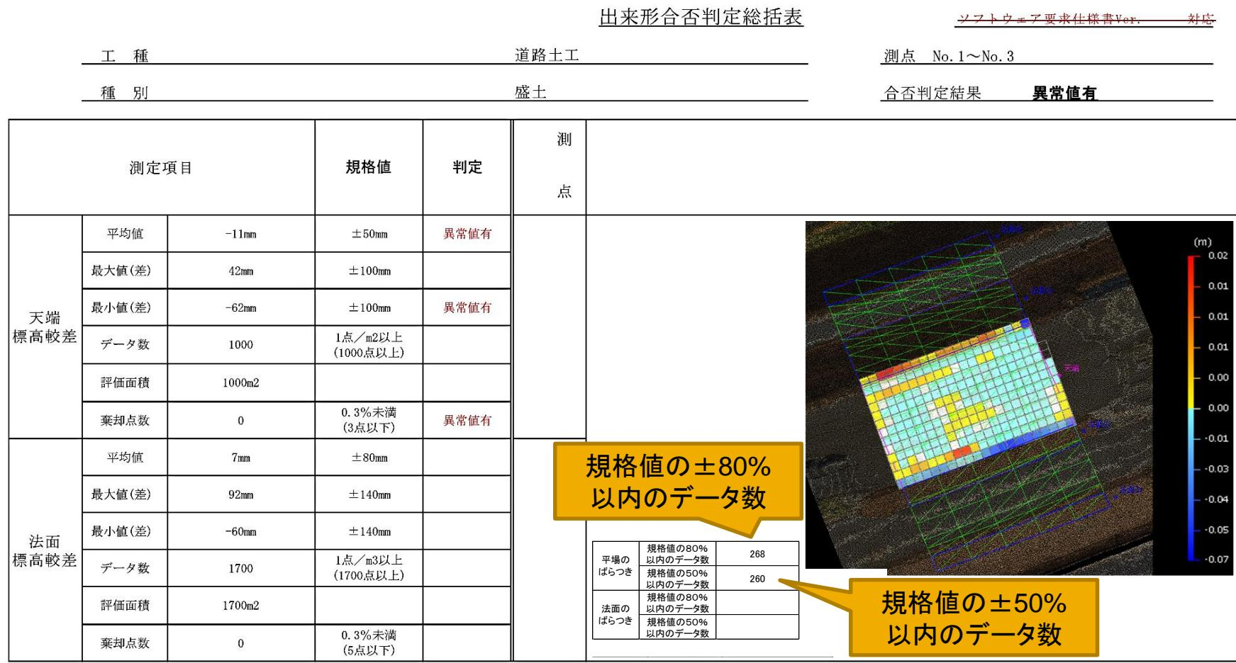
ICT機器を活用し、3次元モデルを用いた検査に対応するように要領・基準を改定。
