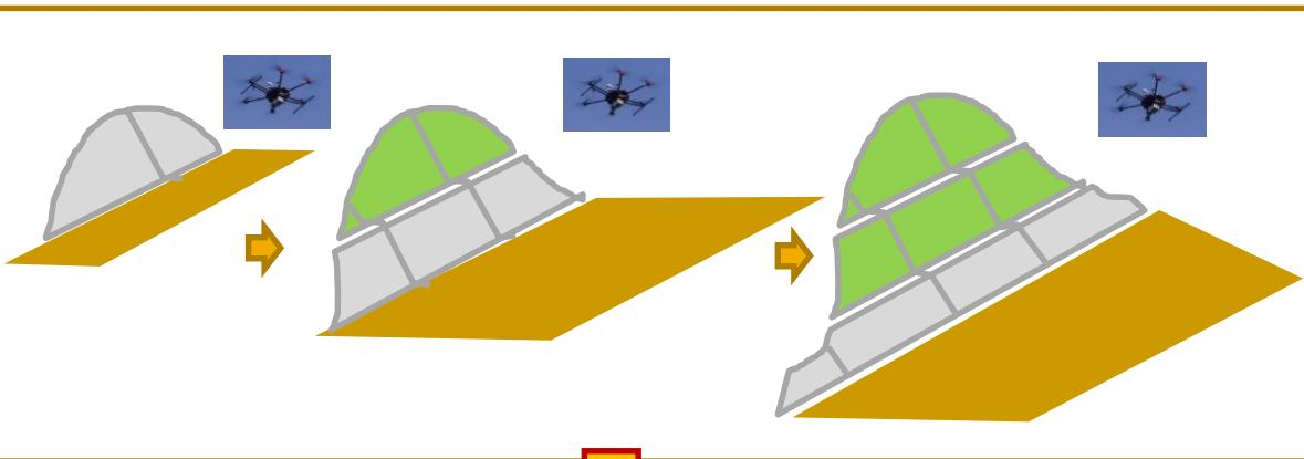
例) 斜面を切り下げながら、法面処理を行う場合、掘削後すぐにアンカーエや法枠等の施工に入ることから、1段ごとに面管理を行わざるを得なくなる。このような場合で、**従来のTS出来形管理**の方が**時間的にも**優位性がある場合が考えられる。
