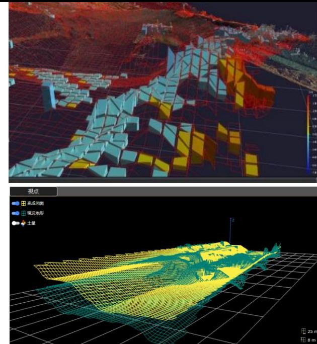
受注者は、UAVやTLSによる計測点群データを基に平均断面法または、3次元CADソフトウェア等を用いた方式により数量算出を行うことができます。
