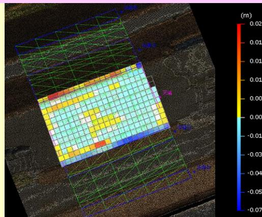
検査員が任意の検査箇所を決め、GNSSを設置し、座標を取得する
