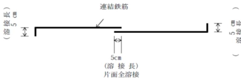
図3-2-1 コンクリートブロックの鉄筋継手
