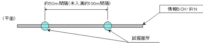
※ケーブル入溝の場合は約50m間隔、未入溝の場合は約100m間隔で試掘を行うこと。
