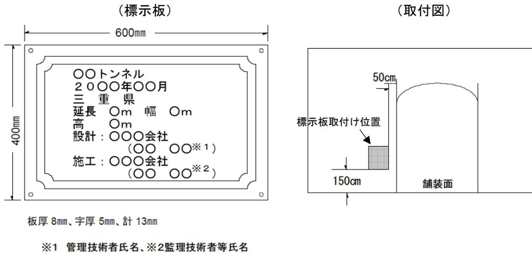
図10-6-2 標示板の設置イメージ図
