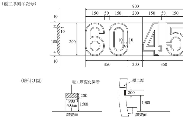
図10-6-1 覆工厚変化箇所の刻示標準図
