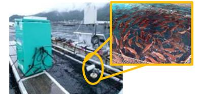
ライブカメラを使用した給餌装置の遠隔操作
