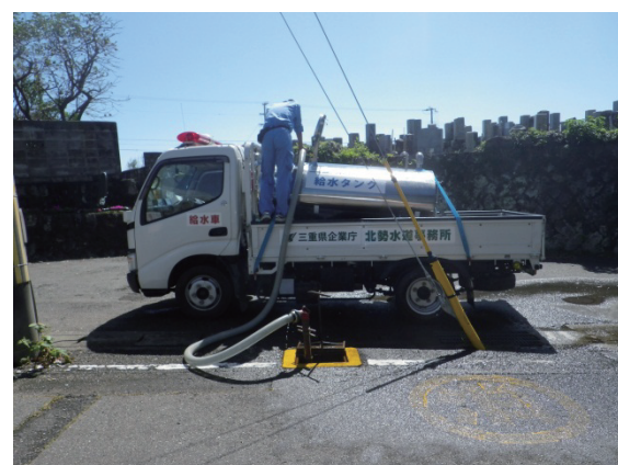
給水車への補給作業（紀宝町）
