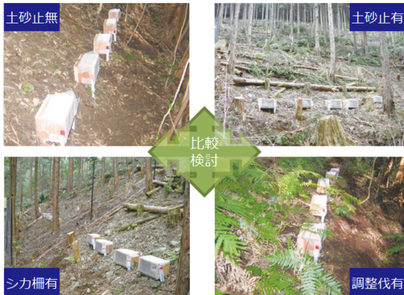
写真 土砂流亡調査実施状況（土砂受け箱の設置）
