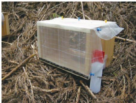
写真 設置した土砂受け箱
