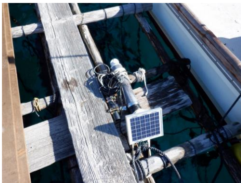
図 1. ICT システムの設置例（真珠養殖筏）
