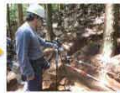
根引き抜き試験
