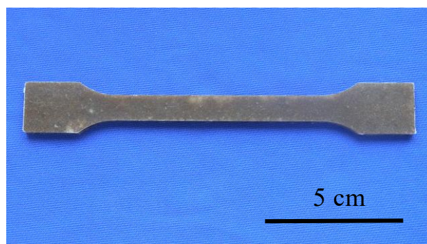
図 2 再生材料と高分子を複合化した試験体
