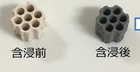
含浸法によって触媒を調製
