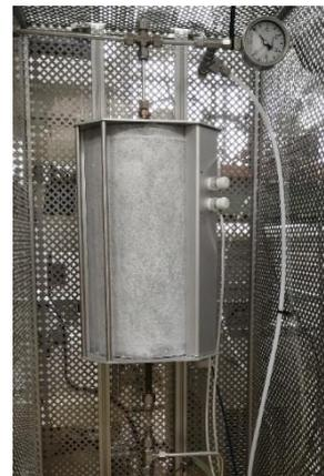
反応管に触媒を詰めて
