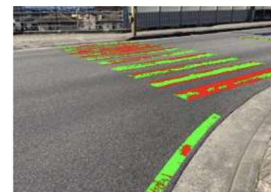
AI路面標示劣化検知システム
