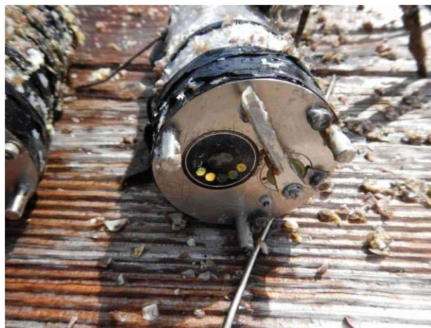
図1. 有害プランクトンセンサー
