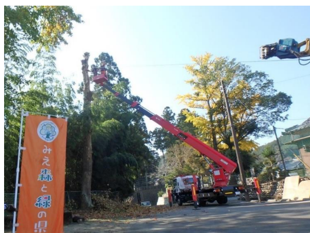
写真8 大紀町野原・御堂垣内地区 作業中 (高所作業車・グラップル使用)
