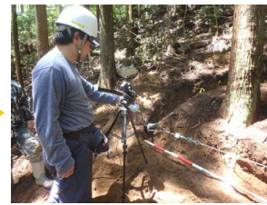
根引き抜き試験
