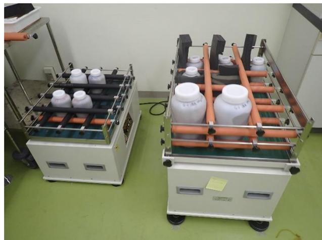
図2 溶出・含有量試験で使用する振とう機
