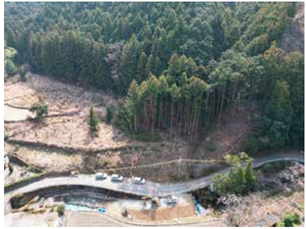
災害からライフラインを守る事前伐採事業 事前伐採事業完了状況
