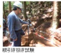
根引き抜き試験
