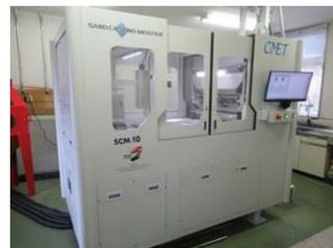
砂型積層造形装置
