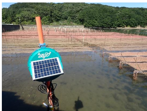
採苗漁場に設置したIoT観測機器
