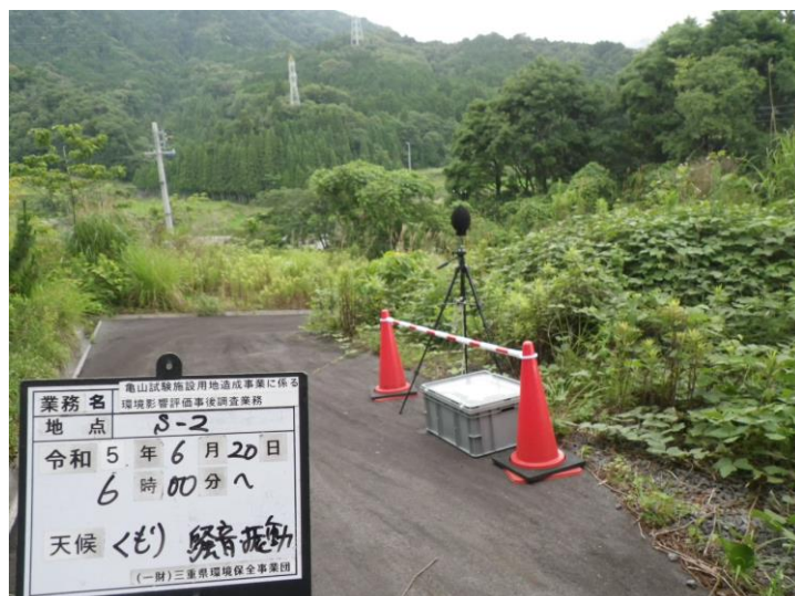
写真①-2 騒音・振動調査状況 (S-2：令和5年6月20日)
