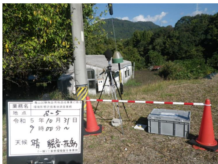
写真①-6 騒音・振動調査状況（S-5：令和 5 年 10 月 31 日）
