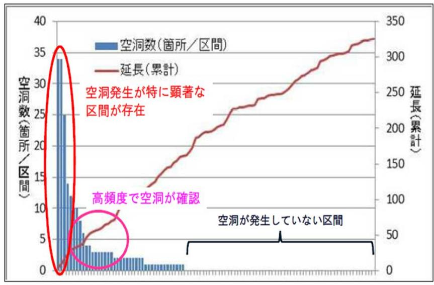
※令和4年度陥没事案のうち陥没深さが判明している事案での分析
