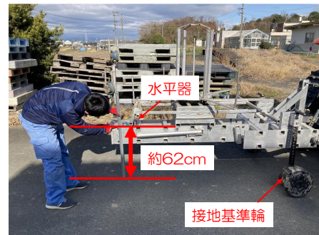
図 14 作業機の調整方法
