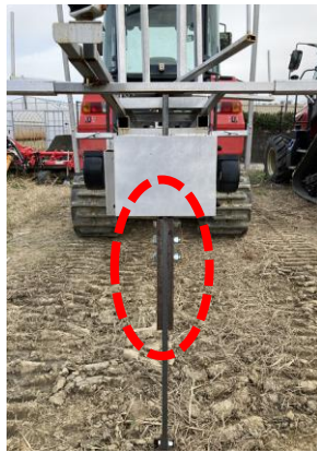
図 16 補強材（左）と縦刃通過に伴い崩れた畦畔（右）
