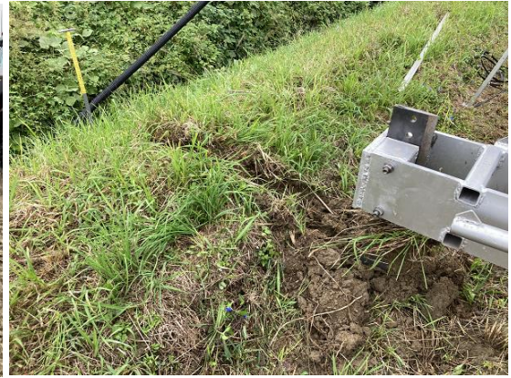
図 16 補強材（左）と縦刃通過に伴い崩れた畦畔（右）
