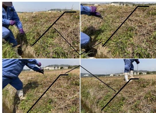
図7 鉄杭による障害物の確認方法
