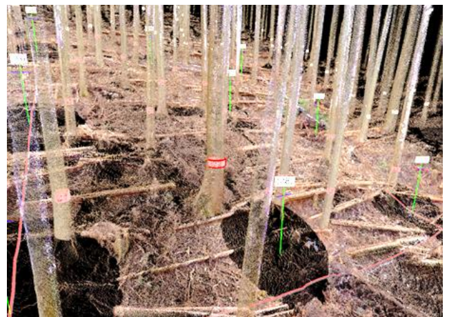
地上レーザ測量による立木と土砂止設置状況の調査
