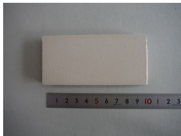
図 2 試作陶磁器質タイル（調合 2，1220 °C 焼成）
