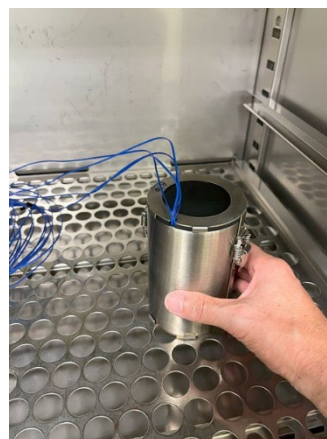
図1 耐熱温度ロガー（開発品）の試験の様子
