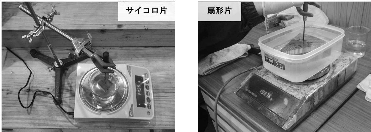
写真-1. 浮力法を用いた各ブロック片の生材体積の測定状況
