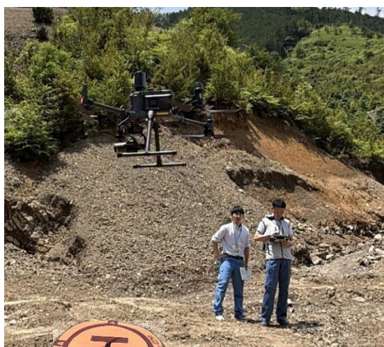
無人航空機（ドローン）を活用した 盛土箇所の立入検査の状況
