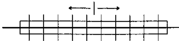
図4-1 ボルト締付け順序
