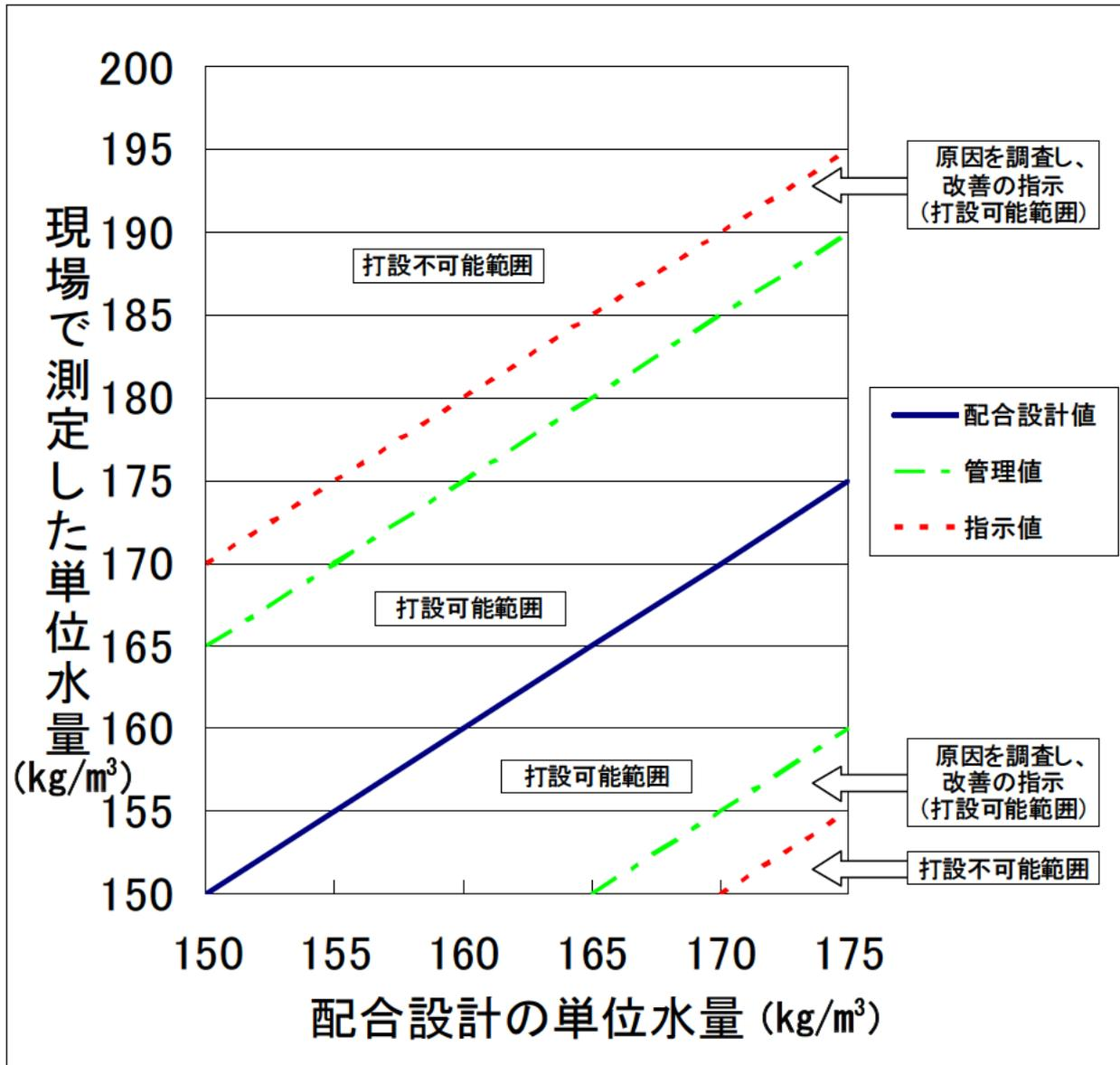
図5-2 レディーミクストコンクリートの単位水量測定の管理図
