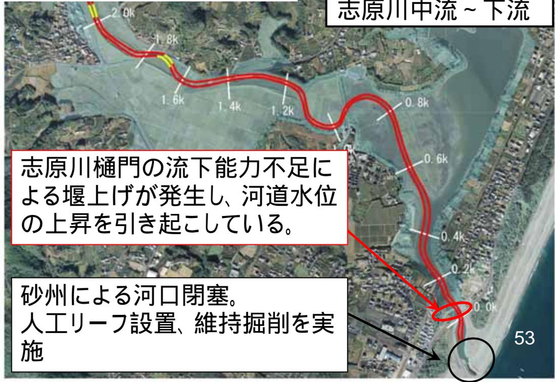
志原川樋門の流下能力不足による堰上げが発生し、河道水位の上昇を引き起こしている。
