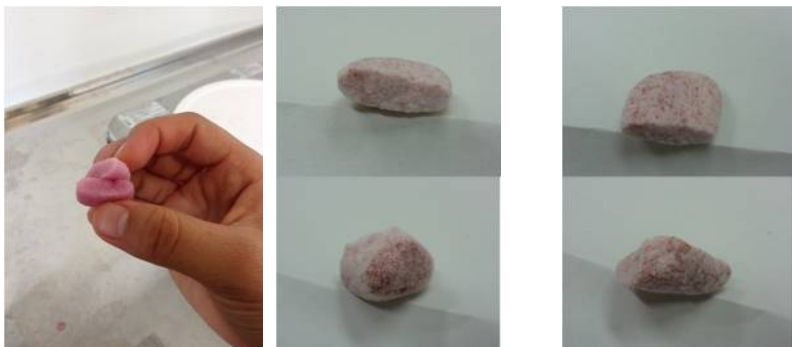
図 6 色水による含浸の確認
