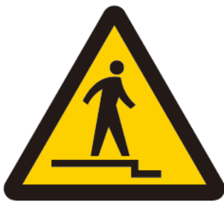
下り段差注意 Caution, uneven access / down
