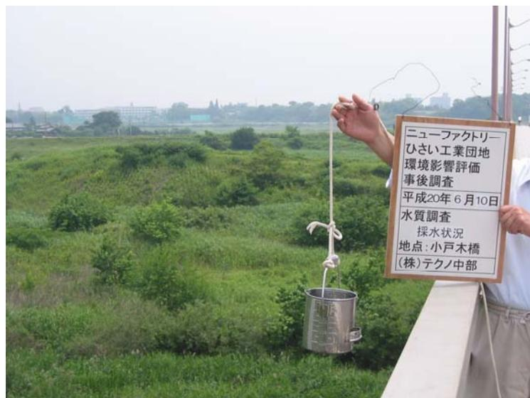
写真1-5 供用後採水状況(作業風景)(平成20年6月10日)
