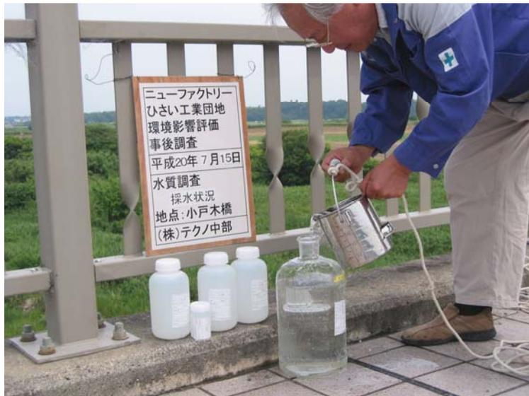
写真1-7 供用後採水状況(作業風景)(平成20年7月15日)
