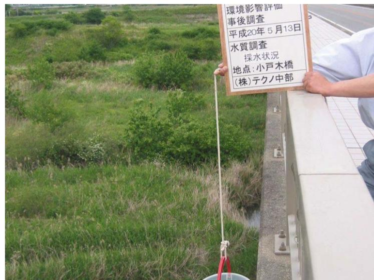
写真1-3 供用後採水状況(作業風景)(平成20年5月13日)
