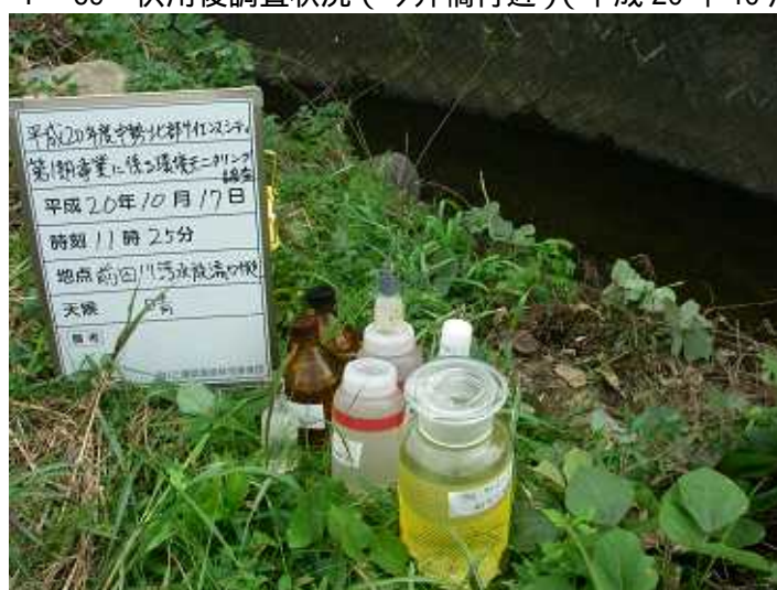
写真4 - 1 - 70 供用後排水調査状況（前田川污水放流口付近）（平成20年10月17日）
