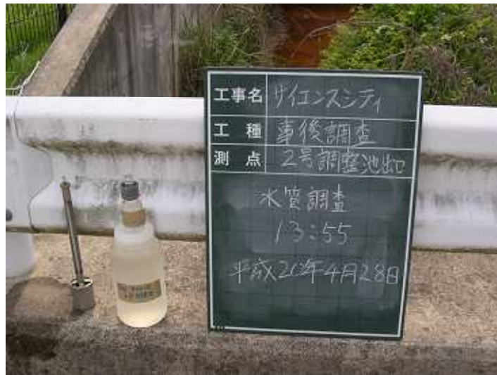
写真4 - 1 - 1 濁水調査状況（通常降雨時）（2号調整池出口付近）（平成20年4月24日）
