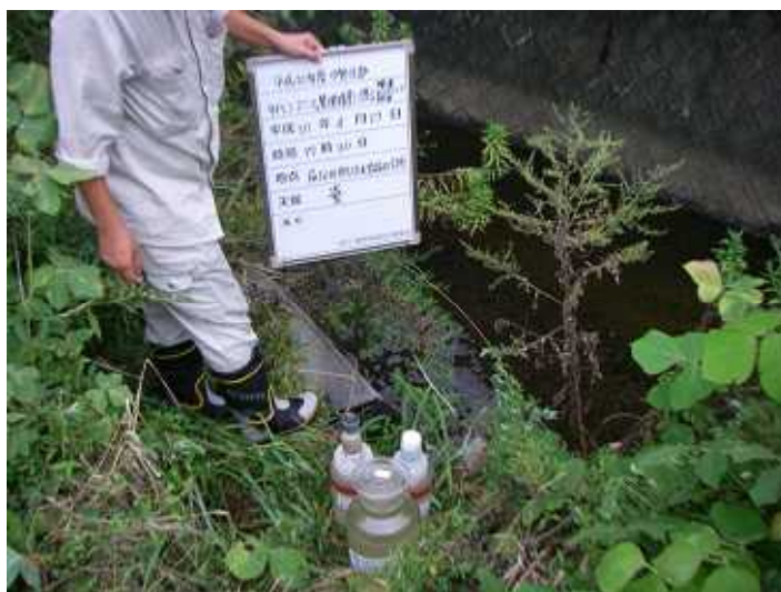
写真 4 - 1 - 66 供用後排水調査状況（前田川污水放流口付近）（平成 20 年 8 月 27 日）
