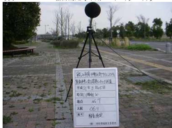
写真4 - 2 - 39 騒音測定（平成21年3月25日） 計画地内
