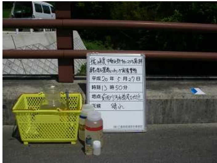
写真4 - 1 - 60 供用後排水調査状況 (前田川污水放流口付近) (平成20年5月27日)
