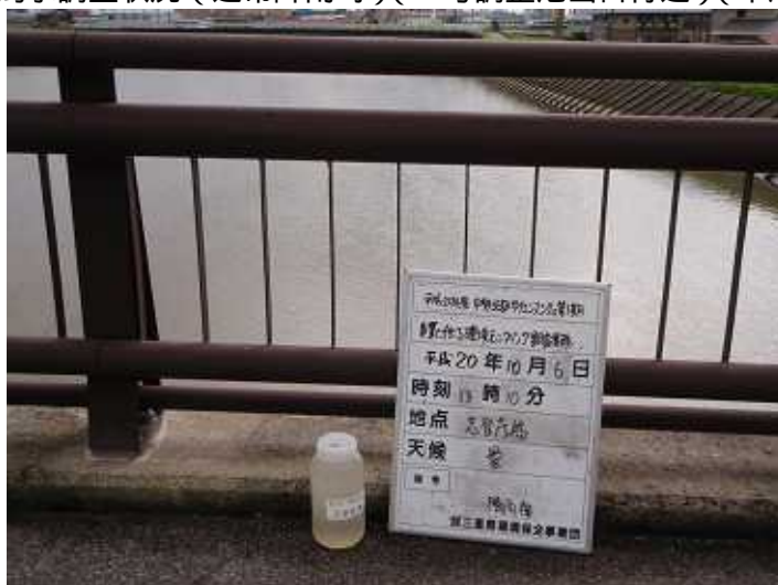
写真4 - 1 - 20 濁水調査状況（通常降雨時）（志登茂橋）（平成20年10月6日）
