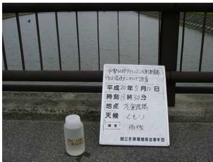
写真4-1-4 濁水調査状況(通常降雨時)(志登茂橋)(平成20年5月12日)
