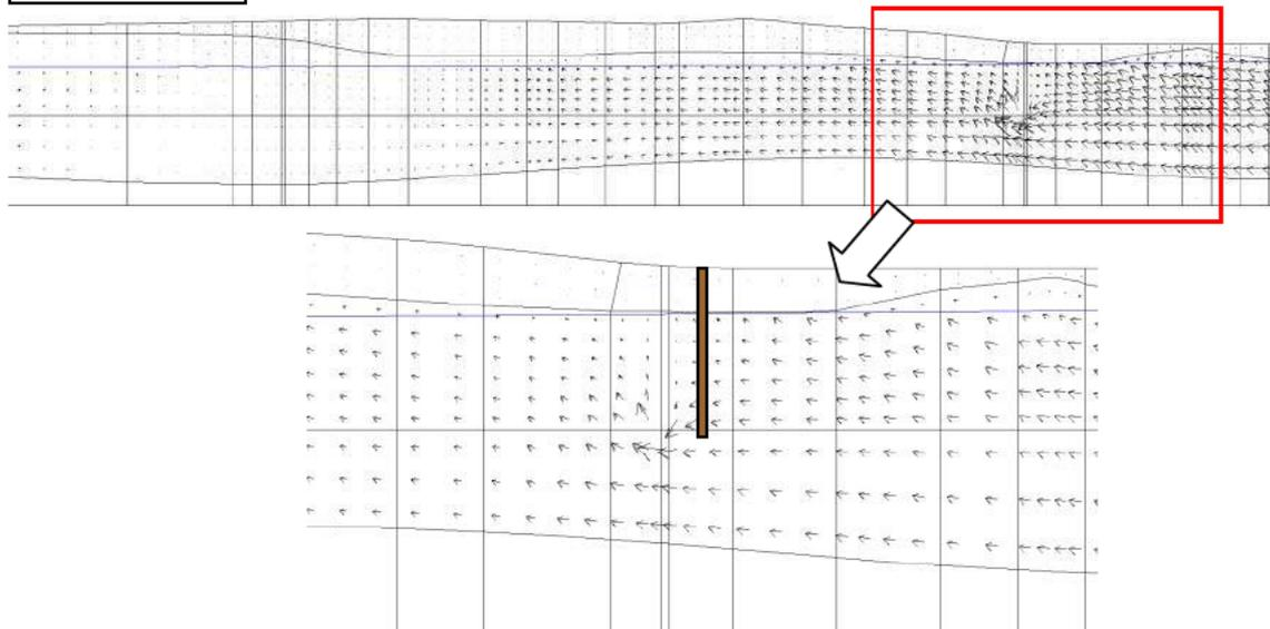
図 4.3 矢板設置後における平常時と高水位時期の流向ベクトル図
