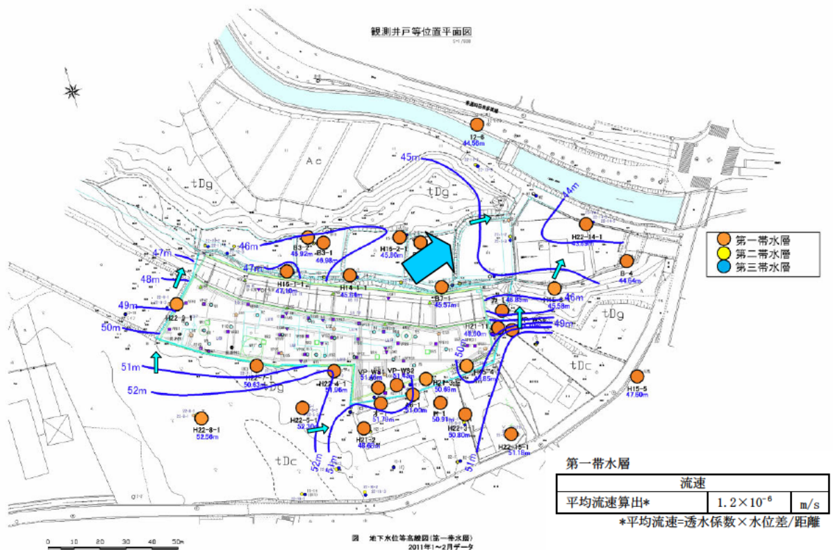
参考図 2.1 地下水位等高線図(第一帯水層)
