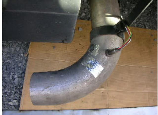
図 8.2 計測設置状況例 (左：車内設置状況、右：排気管へのセンサー設置状況)
