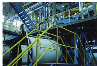
破碎選別装置(バルバー、マルチソータ)
