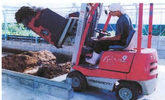
**3. レーン投入**（レーン式自走醗酵マシンに投入）
