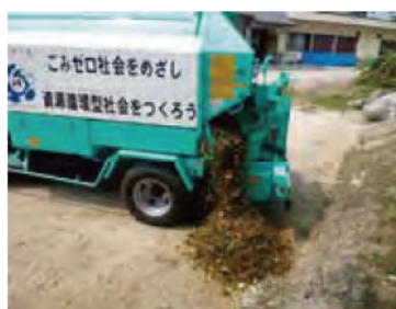
二次破砕機付せん定枝粉碎処理車
